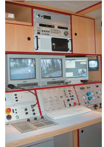
Bild 2: Innenleben eines Kanalinspektionsfahrzeuges
