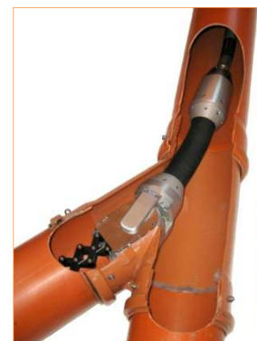
Bild 4: Lindauer Schere im Einsatz
